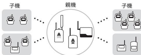
親機の機能により、USB、LAN、LTE通信など多彩な方法でパソコンや無償クラウドサービス、FTPサーバへデータを自動送信。現在値モニタリング・異常時の警報メール送信など自動監視も。用途に合わせたデータ管理システムの構築が可能。
