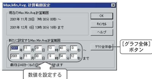
2. [OK] ボタンをクリックすると、チャンネル情報一覧のMax. Min. Avg. が変更になり、グラフは設定された期間が表示されます。
