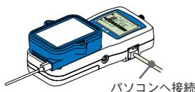
記録開始設定の変更・記録データの吸い上げはパソコンに接続せず、RTR-57C / TR-57C との通信でもできます。詳しくは、RTR-57C / TR-57C 本体の取扱説明書を参照してください。
