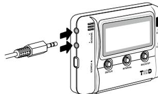
温湿度センサと照度 UV センサは、どちらのセンサ接続ジャックに接続しても測定できます。
