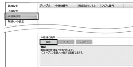
4. 次のような [中継機設定] ウィンドウが表示されたら、中継機として使用する RTR500BC を付属の USB ケーブルでパソコンに接続します。
